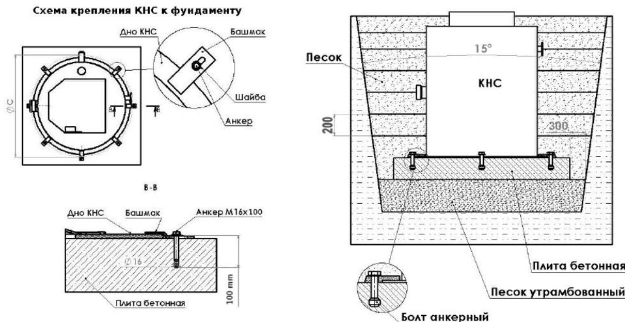
**Вариант №2 с заливкой в бетон корпуса колодца.**
