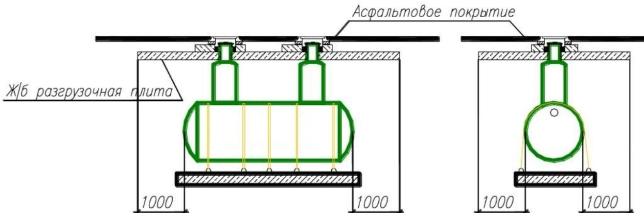
Детализировка узла установки чугунных люков.
