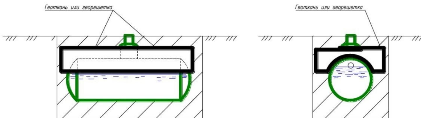
В качестве пригруза против сил всплытия используется собственный вес грунта, который заворачивается в верхней части в слой геосинтетического материала или геосетки.
