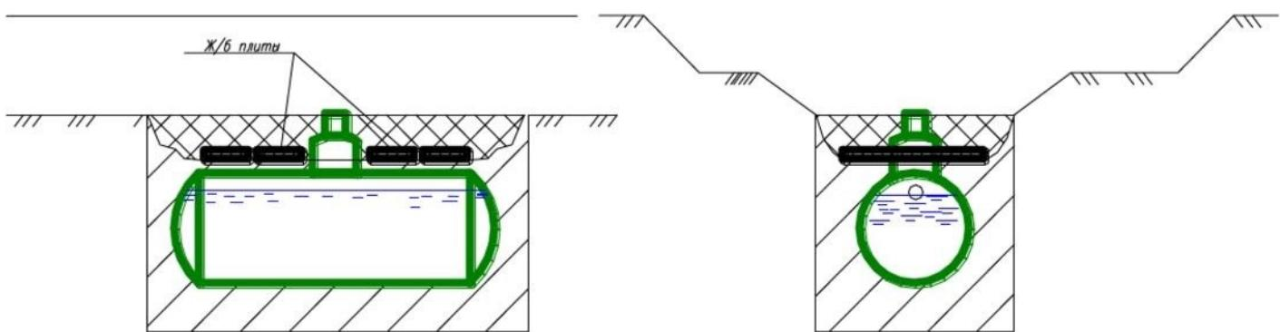
В качестве пригруза используются ж/б плиты укладываемые на песок поверх емкости, которые противодействуют силам всплытия.
