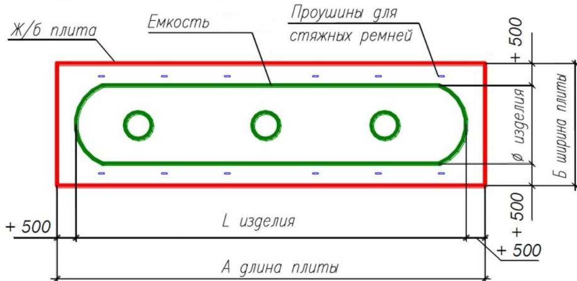
**Схема устройства плит для вертикальных изделий.**
