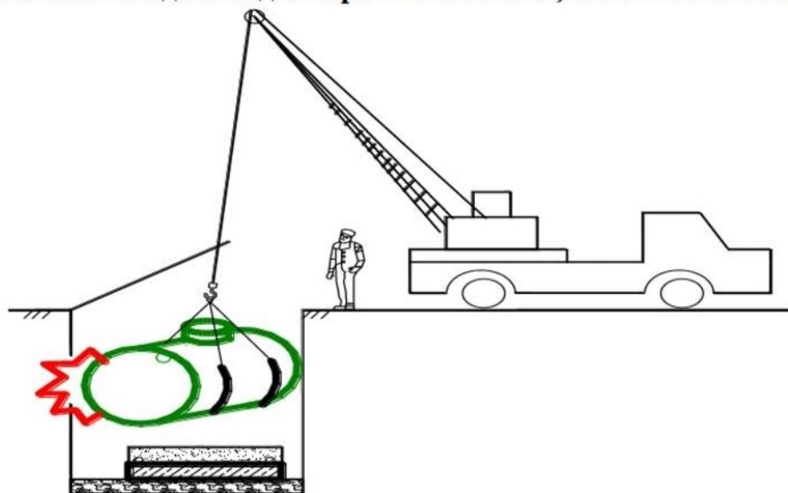
При перерывах в монтаже емкостей необходимо зафиксировать емкости от смещения и всплытия (путем наполнения водой) прикрыть открытые горловины временными заглушками исключить попадания внутрь емкостей грязи или посторонних предметов.
