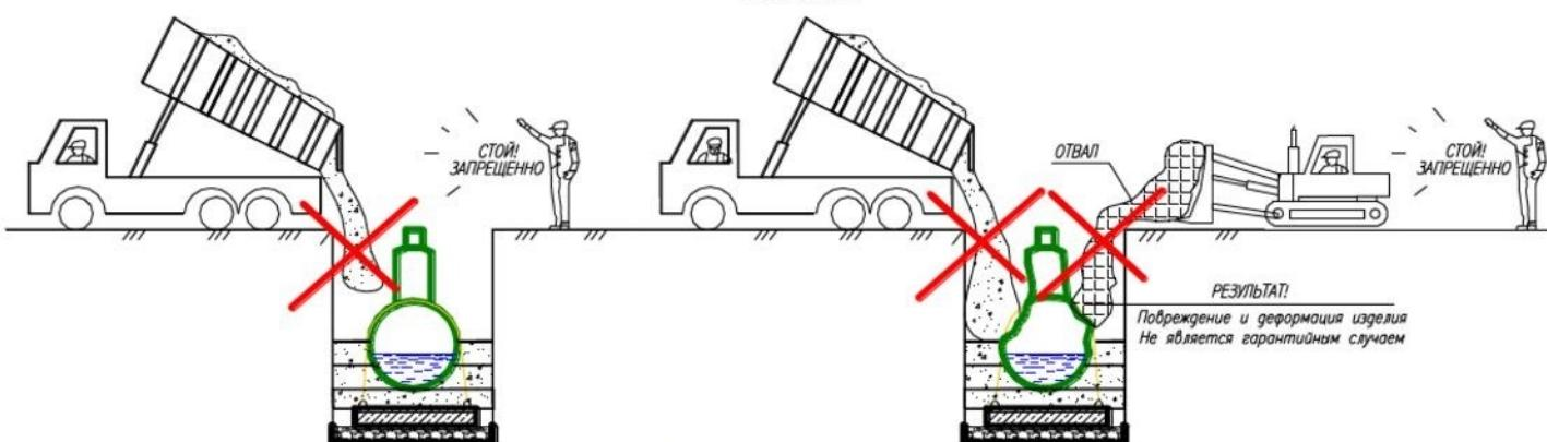
**Запрещается использовать местный грунт и супеси в качестве материала обратной засыпки.**
