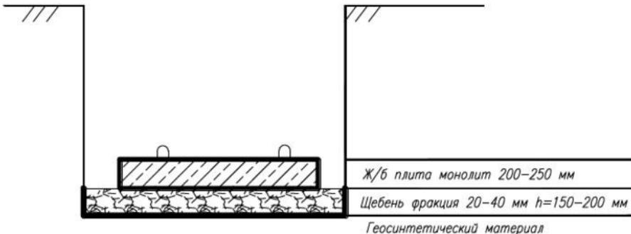
*Вариант №2.* При изготовлении ж/б плиты на дне котлована в качестве основании рекомендуется использовать уплотненный песок или бетонную подготовку.
