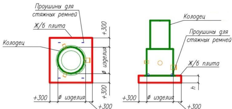
Для армирования плиты рекомендуем использовать арматуру класс АШ диаметром Ø12 мм с шагом 200Х200 мм. При изготовлении плиты внизу котлована достаточно армирования в одну сетку. При изготовлении плиты на бровке котлована рекомендуем армировать в две сетки во избежание поломки плиты при монтаже краном. В качестве закладных деталей (проушина для крепления стяжных ремней) использовать арматуру класс AI диаметром Ø16 мм/
