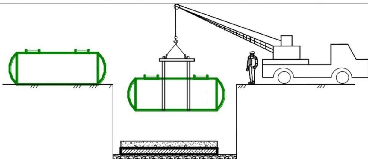
**До начала монтажа проверьте горизонтальность плиты.**
