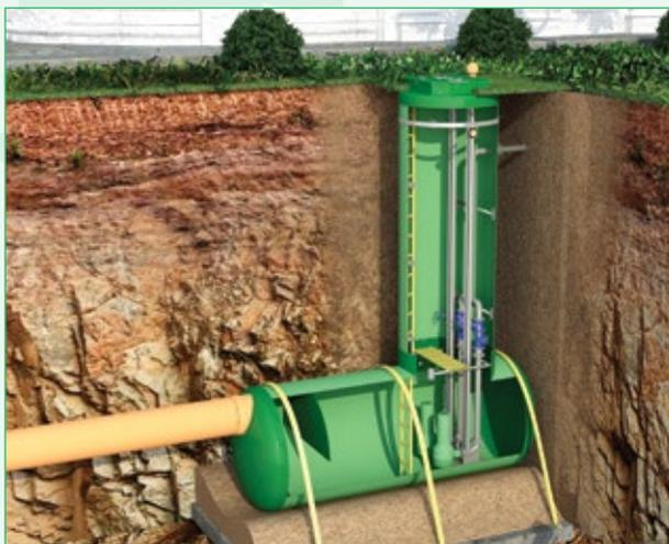
Комплектная насосная станция с горизонтальным корпусом устанавливается на объектах с неравномерным поступлением стоков в КНС или на очистные сооружения. Резервуар станции аккумулирует залповый сброс дождевых стоков и насосы в штатном режиме перекачивают воду. Комплектная насосная станция с горизонтальным корпусом не просто аккумулирует стоки, насосы перекачивают накопленный объем в часы наименьшего потребления электричества.
