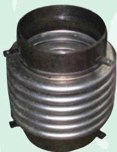
При монтаже КНС в сейсмически опасных районах для компенсации сдвиговых перемещений трубопроводной арматуры применяются компенсаторы сильфонные.
