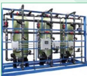
При прохождении воды через ионообменную смолу происходит удаление солей жесткости (кальция и магния) за счет замены их на ионы натрия. Восстановление ионообменной ёмкости происходит путем регенерации ее раствором поваренной соли из расчета 4,5- 5 кг на каждые 28,3 л наполнителя при обратной промывке фильтра.
