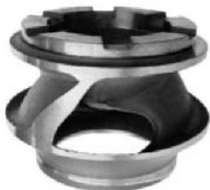
Рис.23 Двухканальное рабочее колесо S-2 фирмы GRUNDFOS. Надежное противостояние засорению получено за счет установки удлиненных лопастей и диагональной конструкции рабочего колеса. Симметричная конструкция сбалансирована изначально.
