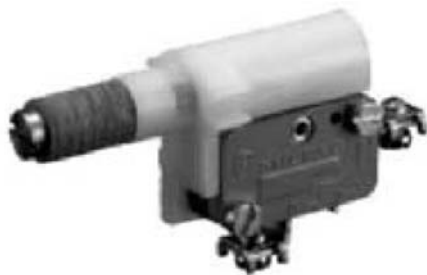
Рис.42 Реле влажности фирмы GRUNDFOS. Прибор состоит из набора чувствительных к влаге дисков, собранных на приводной штанге, и микровыключателя. Впитывая избыточную влагу и расширяясь, гигроскопичные диски давят на приводную штангу. Кулачок, установленный на конце штанги, приводит в действие микровыключатель и размыкает цепь питания. Прибор не обладает способностью возвращаться в исходное положение и должен быть переустановлен после срабатывания.
