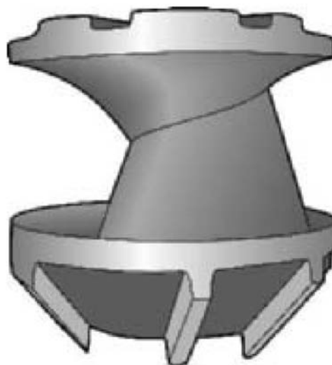
Рис.22 Одноканальное рабочее колесо S-1 фирмы Grundfos, используемое в канализационных насосах. Рабочее колесо выполнено в виде диагональной конструкции с одной длинной лопастью, обеспечивающей надежное противостояние засорению. Асимметричность конструкции требует наличия противовесов в целях обеспечения статической и динамической балансировки рабочего колеса.
