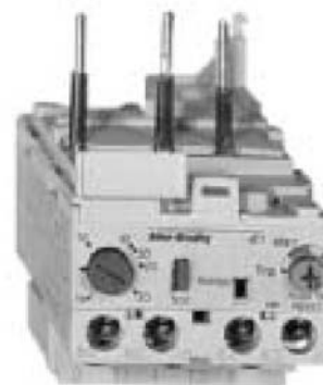
Рис.43 Тепловое реле перегрузки. Реле подсоединено к клеммам двигателя и разрывает цепь питания, когда электрическая нагрузка превышает установленную величину.
