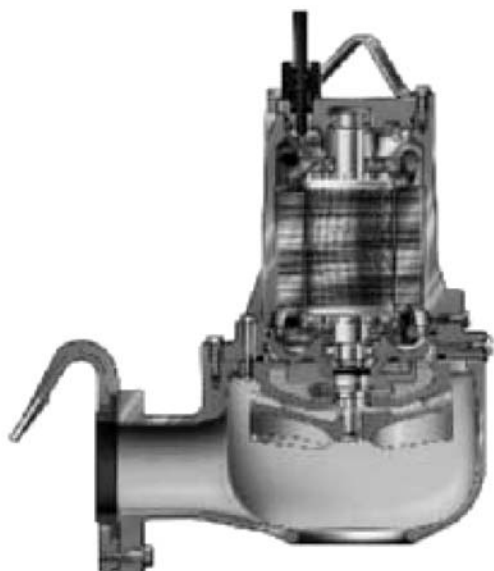
Рис.15 Поперечный разрез погружного насоса мощностью 2,4 кВт фирмы GRUNDFOS, на котором изображены детали насоса и двигателя. Насос снабжен специальными направляющими клыками для соединения с установленной на дне резервуара на плите-основании системой автоматической трубной муфты, обеспечивающая простоту установки и демонтажа насоса.
