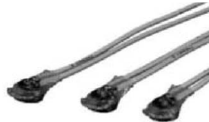
Рис.41 Термовыключатель. Устройство состоит из биметаллического микровыключателя, который размыкает цепь в соответствии с заданной температурой. Выключатель подсоединен к панели управления, чтобы разомкнуть цепь питания двигателя в случае его перегрева.
