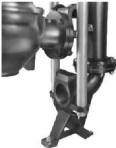
Рис.44 Автоматическая трубная муфта фирмы GRUNDFOS. Насос надежно удерживается на месте посадки своим весом. Точно обработанные контактные поверхности и резиновые уплотнительные кольца обеспечивают герметичность соединения. Зазор между направляющими клыками и трубами обеспечивает беспрепятственный подъем насоса даже в случае загрязнения.
