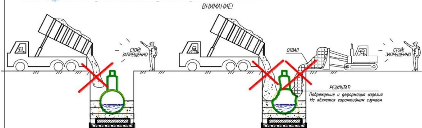
**Запрещается использовать местный грунт и супеси в качестве материала обратной засыпки.**
