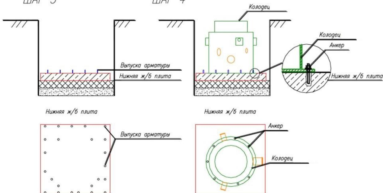
**ШАГ 3:** Залейте бетонную плиту на высоту  $h=100$  мм. Смонтируйте стеклопластиковый колодец на нижнюю плиту.
