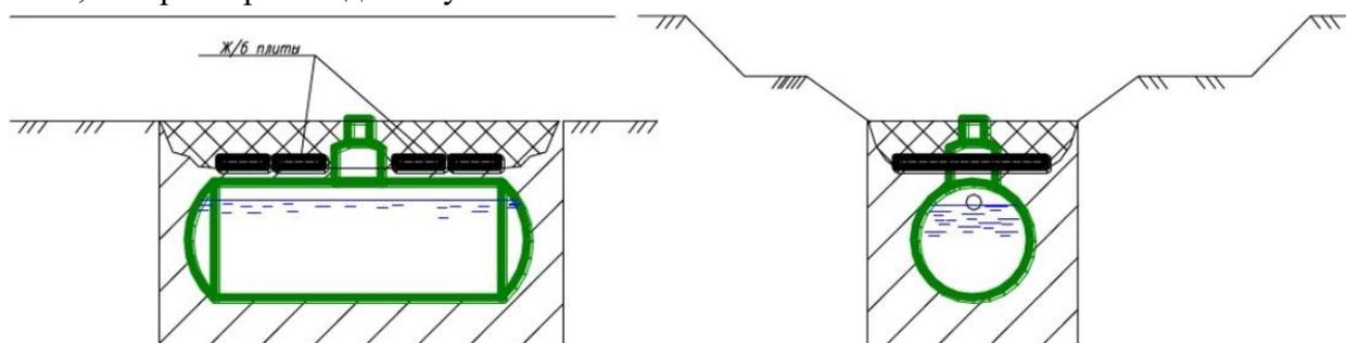
**Схема 2:** В качестве пригруза против сил всплытия используется собственный вес грунта, который заворачивается в верхней части в слой геосинтетического материала или геосетки.
