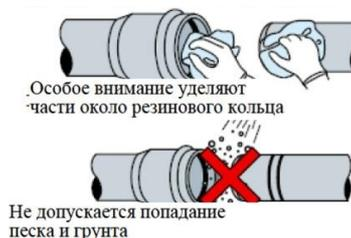
2) На резиновое кольцо внутри раструба трубы, чистой материей наносят тонкий слой смазки (жидкое мыло);
