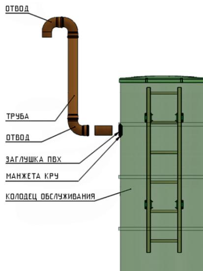
На боковой поверхности колодца может быть предусмотрено отверстие для дополнительной вентиляции емкости. Отверстие закрыто канализационной заглушкой. Необходимость установки вентиляции определяется проектом.
