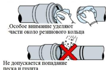
2) На резиновое кольцо внутри раstrуба трубы, чистой материей наносят тонкий слой смазки (жидкое мыло);
