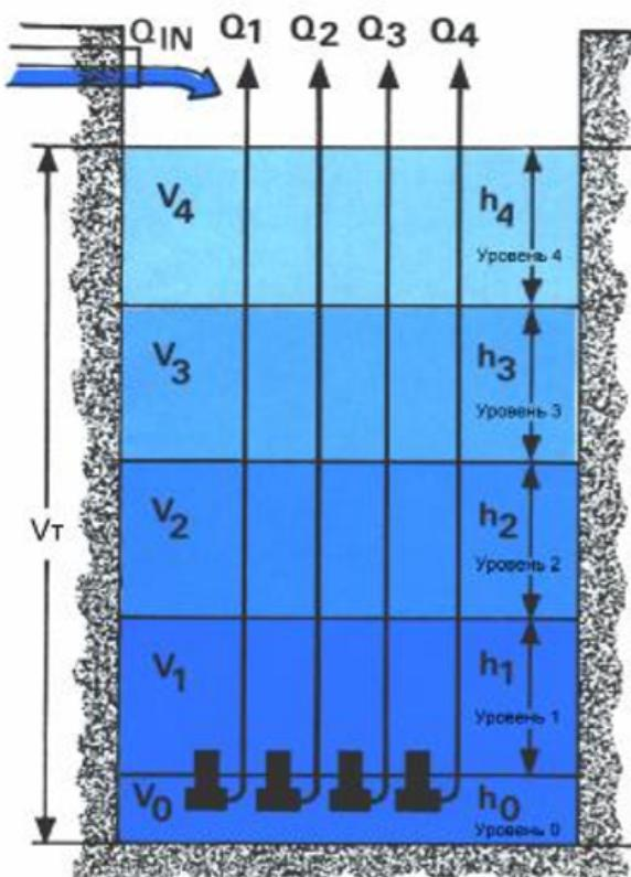
Рис.4 Функциональная схема 4-х насосной станции.
