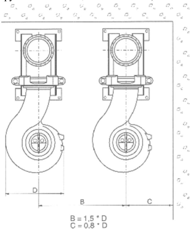
**Рис.1 Рекомендуемые размеры для установки погружных насосов Grundfos.**
