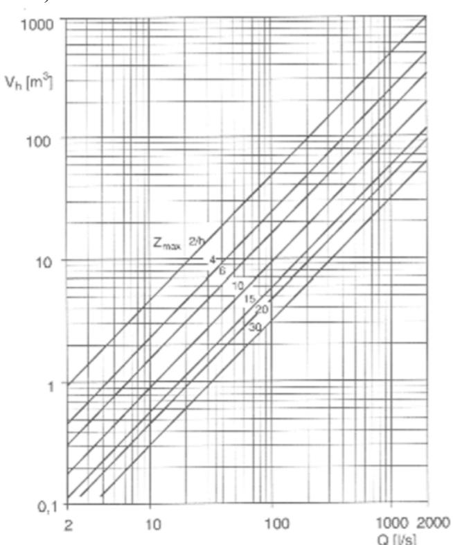
**Рис.2 Номограмма для определения регулирующего объема колодца.**
