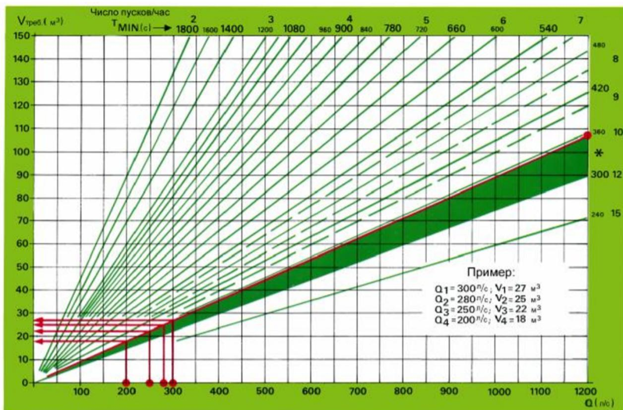
Рис.8 Диаграмма расчета объема колодца при работе насосов по схеме 1.
