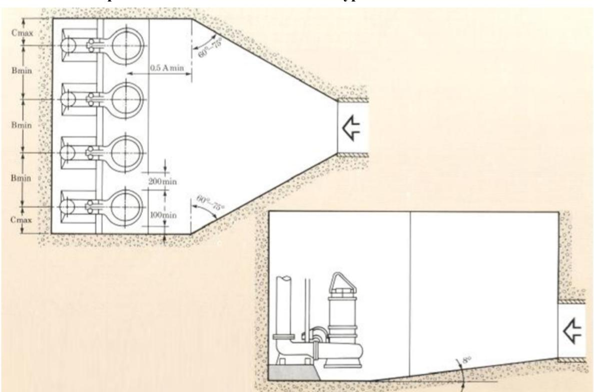
Рис. 16 Насосная камера с фронтальным придонным вводом.
