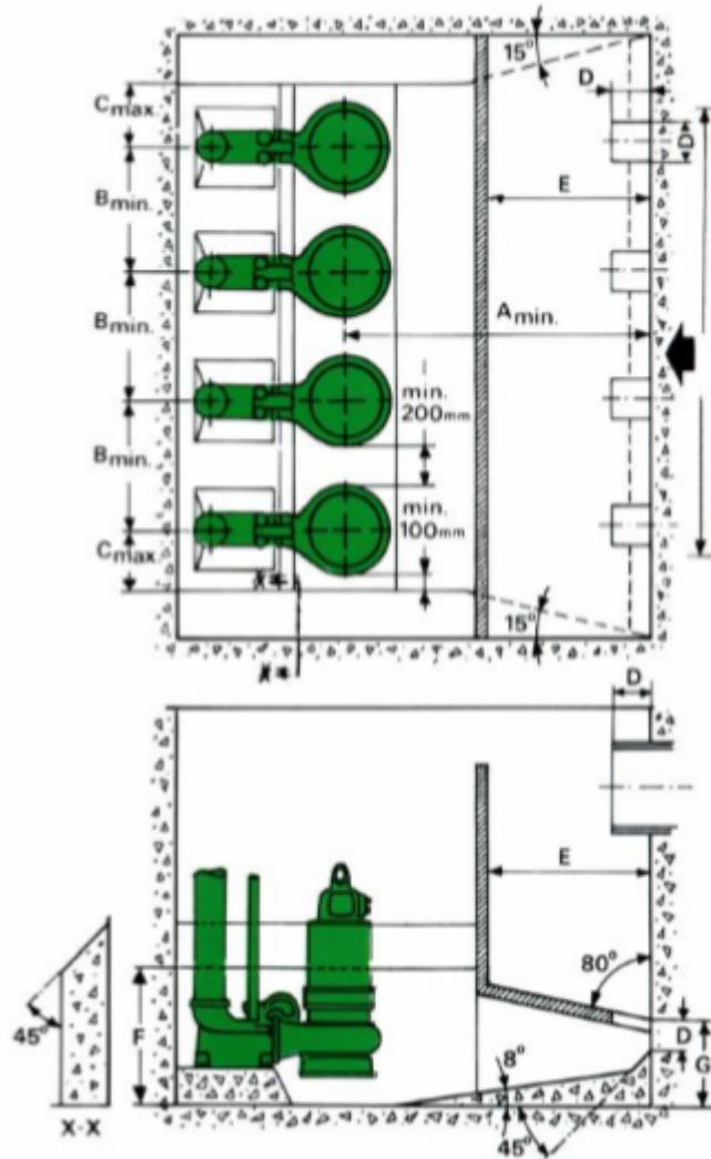
**Рис.12 Модель насосного колодца Flygt**
