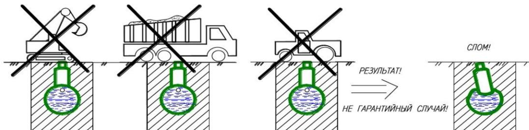
Запрещается движение автотранспорта и тяжелой строительной техники после обратной засыпки котлована с установленными в нем стеклопластиковыми изделиями в избежание повреждений. Движение техники допускается на расстоянии не менее двух метров от стенок емкости.
