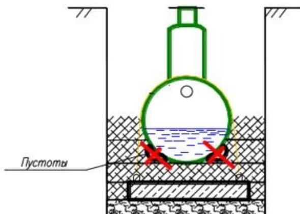
В качестве материала обратной засыпки применяется строительный песок. При использовании песка не допускается наличия в нем крупных валунов размером более 50 мм, глинистых комков, строительного мусора и т.д.
