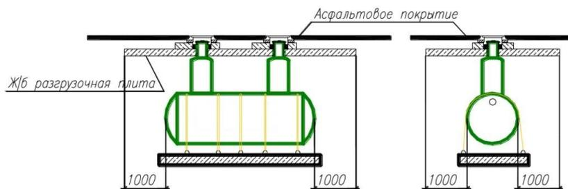
Детализировка узла установки чугунных люков.
