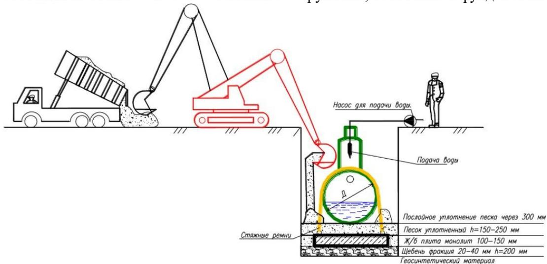
Одновременно с обратной засыпкой необходимо выполнить наполнение стеклопластиковых емкостей водой для предотвращения её всплытия, выдавливания и смещения.
