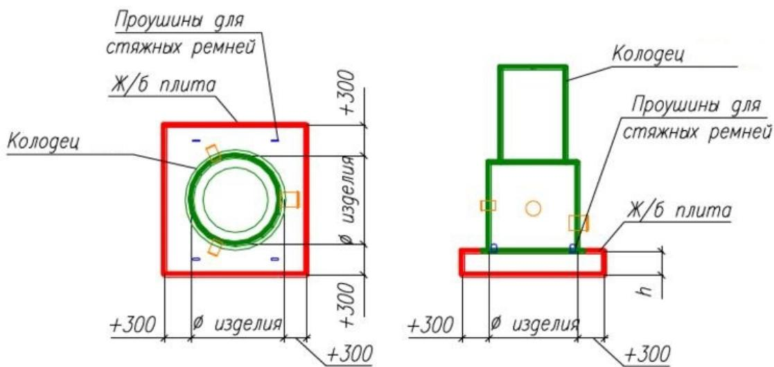
Для армирования плиты рекомендуем использовать арматуру класс АIII диаметром  $\varnothing 12$  мм с шагом  $200 \times 200$  мм.
