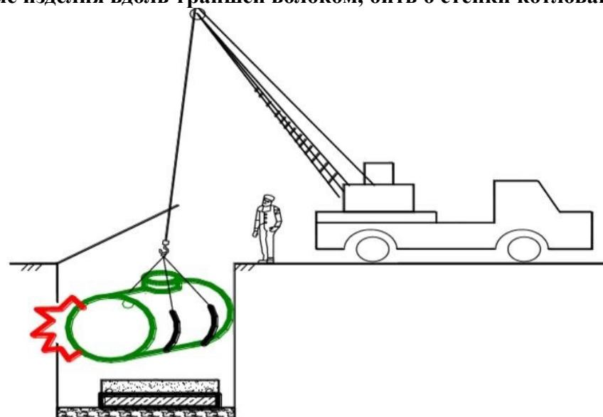
При перерывах в монтаже емкостей необходимо зафиксировать емкости от смещения и всплытия (путем наполнения водой) прикрыть открытые горловины временными заглушками исключить попадания внутрь емкостей грязи или посторонних предметов.
