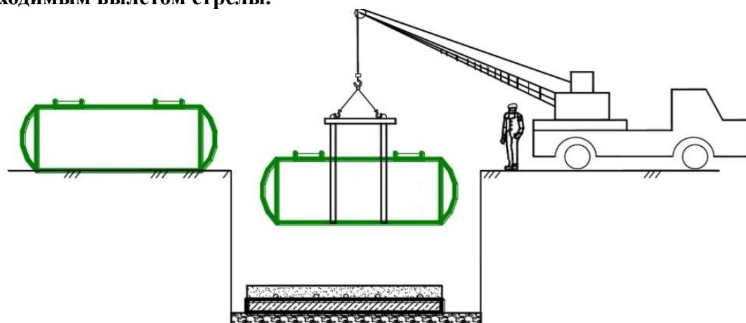
До начала монтажа проверьте горизонтальность плиты.
